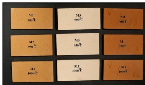
Fig. 16 – Carreaux céramiques fabriqués à partir des trois mélanges M1, M2 et M3
